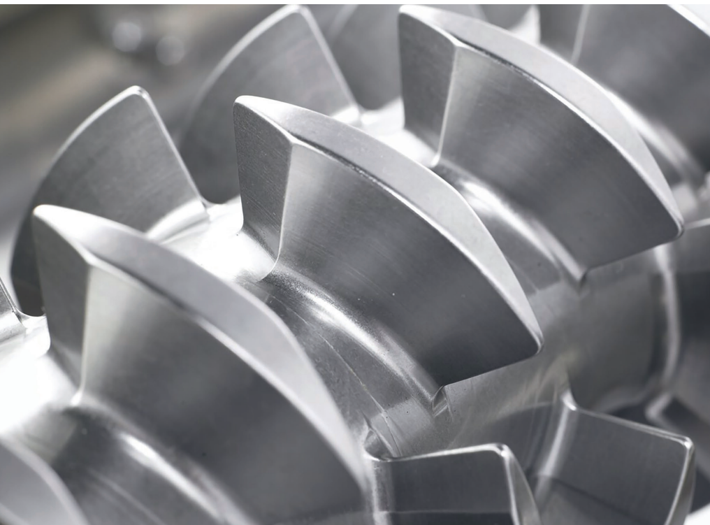
Herzstück der Ko-Kneter-Technologie ist eine temperierte, oszillierende Schneckenwelle.
