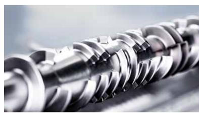
Neuartige Aufschmelzelemente ersetzen z.B. bei Kabelanwendungen den Stauring im Knetergehäuse.
