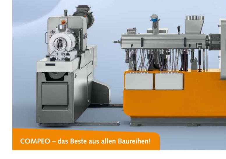
"Excellence in Compounding" ist der Anspruch, der alle Produkte und Leistungen von BUSS vereint. Die neue Compounder-Generation COMPEO vereint die Vorteile aller BUSS Baureihen. Entstanden ist ein aus standardisierten Modulen konfigurierbares Compoundiersystem, das für die Aufbereitung praktisch der gesamten Kunststoffpalette eingesetzt werden kann.
