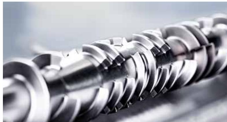
Neuartige Aufschmelzelemente ersetzen z.B. bei Kabelanwendungen den Stauring im Knetergehäuse.
